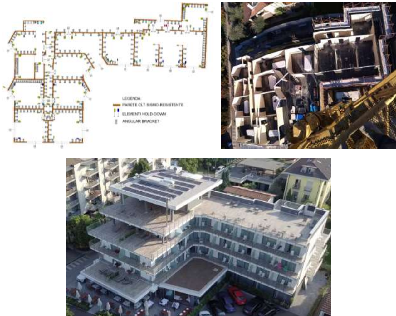
Fig. 2. Estratto di progetto strutturale azienda STP e vista dall'alto delle pareti e dei sistemi di connessione utilizzati per il collegamento tra pannelli CLT-fondazione (sopra). Vista globale dell'edificio ultimato ed in funzione (sotto).
