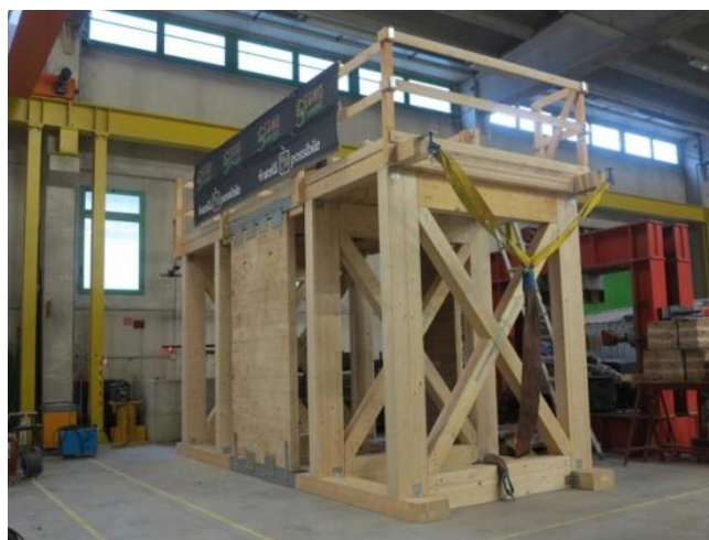
Figura 5. Prototipo edificio monopiano
